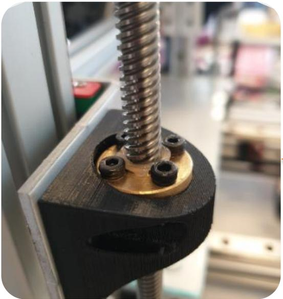
IL EST NÉCESSAIRE DE GRAISSER RÉGULIÈREMENT LES 2 TIGES TRAPÉZOÏDALES DE VOTRE IMPRIMANTE À L'AIDE D'UNE GRAISSE PTFE DISPONIBLE SUR NOTRE SHOP EN LIGNE
