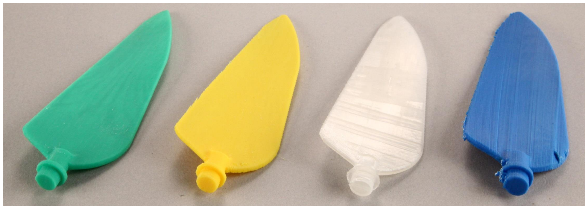
Pale d'éolienne. Longueur 120 mm. Pièces obtenues avec ; de gauche à droite : UP EASY120 – UP EASY 100 – Replicator 2 - Cube
