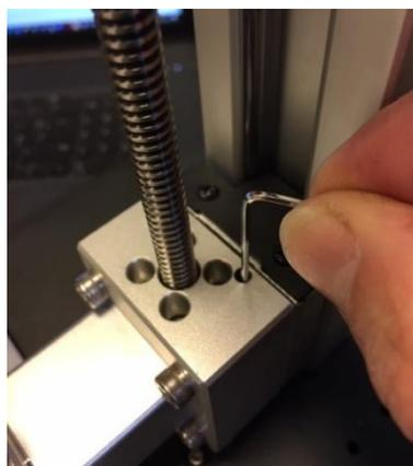
*Lamelle du capteur optique de fin de course sous le chariot vertical.
