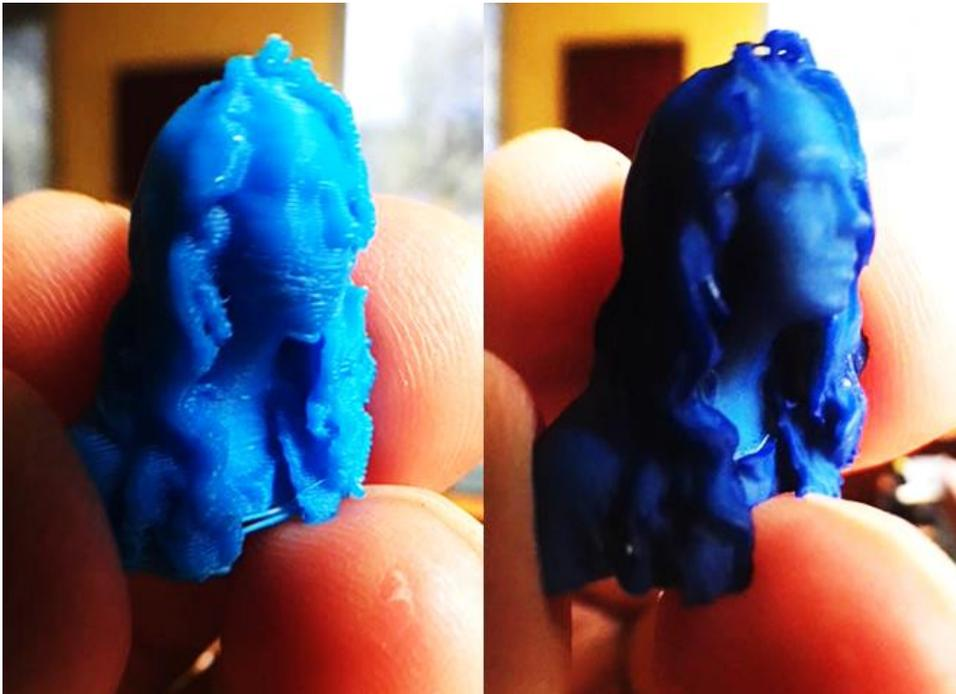
*A gauche une petite pièce réalisée sur une bonne imprimante fdm (UP BOX+ ; couches de 0,2 mm).*
