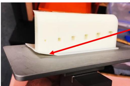
*Autre exemple de pièce partiellement décollée du plateau de construction.*
