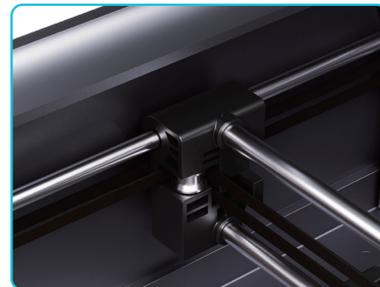
5. La lentille de sortie du module laser, le déflecteur d'air et les entrées d'air des ventilateurs latéraux. Le module laser nécessite un entretien périodique complet avec démontage du boîtier.
